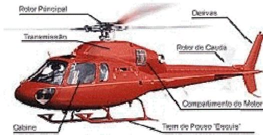
O rotor principal é primordial por dois motivos: porque é ele que produz a sustentação que autoriza o vôo, permitindo, através de manobras coordenadas do piloto, que o helicóptero se mova para cima e para baixo, para a frente e para trás e ainda para os lados e porque uma falha de rotor principal, geralmente, tem conseqüências catastróficas.
