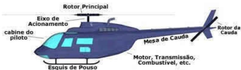
**As peças fundamentais de qualquer helicóptero**
