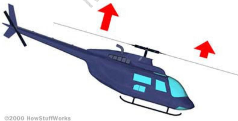
O coletivo permite que você mude o ângulo de ataque do rotor principal nas duas pás simultaneamente
