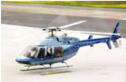
Helicóptero — do grego hélix (espiral) e ptéryks (asa) — é uma aeronave de asas rotativas, mais pesada que o ar, propulsada por um ou mais rotores horizontais maiores (propulsores) que, quando girados pelo motor, criam sustentação e propulsão necessárias para o vôo. Devido ao fato de as pás do rotor girarem em torno de um mastro, são classificados como aeronave de asa rotativa, o que os distingue das aeronaves de asa-fixa convencional (avião).
