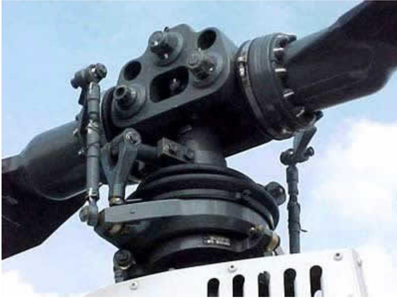
O cubo da hélice do rotor principal, onde as pás e o prato oscilante se conectam, tem que ser muito forte e ajustável. O conjunto do prato oscilante é o componente que fornece ajustabilidade.
