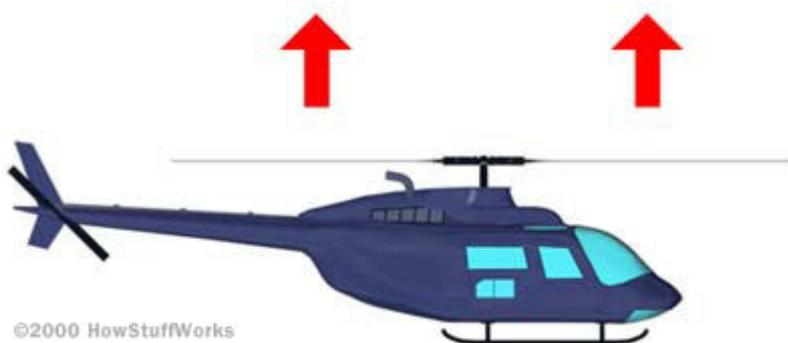
O comando coletivo muda o ângulo de ataque nas duas pás simultaneamente.
