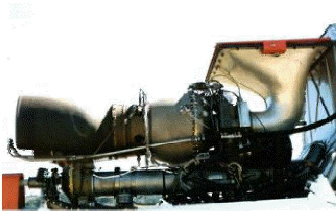
Motores de helicóptero giram a muito alta velocidade, enquanto os seus rotores têm de girar a velocidades muito baixas. Como as turbinas dos turbomotores giram a velocidades da ordem de 50.000 rpm (Rotações Por Minuto), torna-se necessário acoplar ao eixo de saída da turbina de potência um trem de engrenagens de forma que o eixo de saída do motor gire a uma rotação aproximada de 6.000 rpm.
